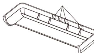
Если проводка смонтирована открытым способом, можно проделать отверстия в наружном корпусе.
