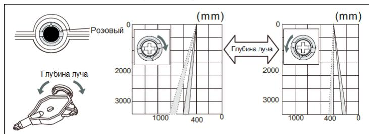
Используйте инструмент регулировки для регулировки правой и левой ширины.
