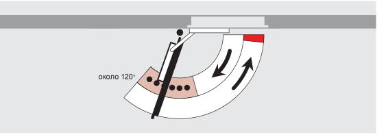
Механический ограничитель угла открывания.
