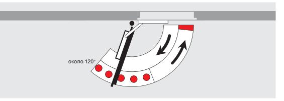
Механический фиксатор открытого положения (RF).
