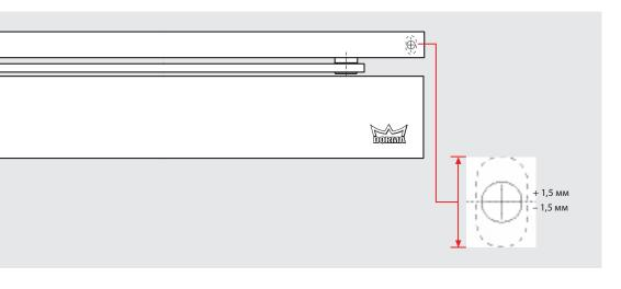
Регулировка скользящего канала по высоте позволяет легко устанавливать доводчики на любую конкретную дверь.
